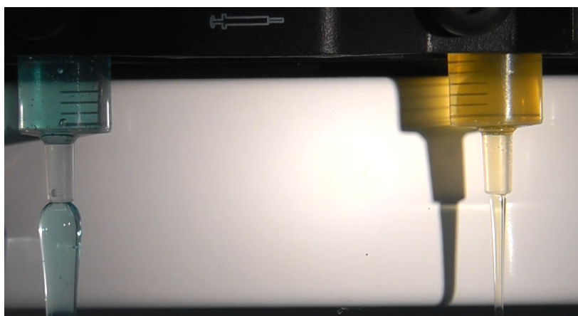
Captura del vídeo donde se observa el efecto Barus (ETH Soft Materials Zürich)
