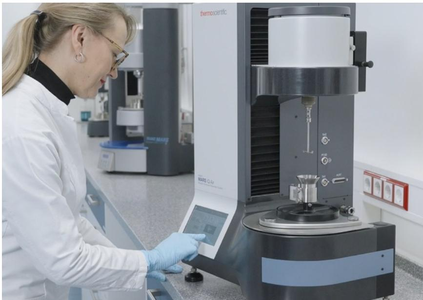
*Configuración del reómetro HAAKE MARS iQ para reología de polvos: ejecutar un SOP con solo presionar un botón.*
