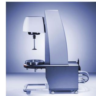
El diseño especial del MCR 502 WESP de Anton Paar, con su caja electrónica separada y su torre de medición aislada, abre nuevas posibilidades y situaciones que permiten beneficiarse de las mediciones ópticas del reómetro confocal y del reómetro de forma simultánea. Todo ello, con las mejores especificaciones para reometría clásica, DMA o SMT.
