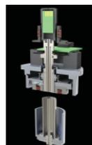
Un control preciso de las temperaturas del plato inferior y superior es vital para la una mayor precisión de la mayoría de las medidas reológicas. El DHR contiene la tecnología ATC patentada que permite medida directa sin de las temperaturas tanto del plato superior como del inferior. Esto resulta en una rápida respuesta y eliminación de complejas calibraciones. [Más información](#)
