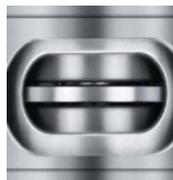
El DHR es el único reómetro comercial que posee tecnología de cojinetes magnéticos. Esta segunda generación patentada proporciona una mejora sustancial en las medidas de bajo torque y una gran estabilidad del "mapping". Disminuye dicha fricción en un 70 % lo que permite que el motor del DHR mida hasta 0.5 nNm de torque.
