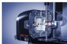
Su interior metálico fabricado por impresión 3D garantiza el control y una distribución absolutamente homogénea de la Temperatura, sin gradientes, entre -160 °C y 600 °C. Válida para el uso flexible de los reómetros MCR para todo tipo de mediciones reológicas, de DMTA en torsión
