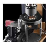
El accesorio de Microscopía para los reómetros Híbridos Discovery permite la visualización completa de la muestra incluyendo contrarrotación en conjunto con medidas reológicas. El sistema consta de una cámara de alta resolución de hasta 90 fps que proporciona las imágenes en conjunto con un microscopio con aumentos de hasta 100x.
