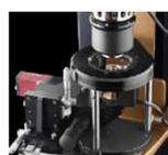
El accesorio de Microscopía para los reómetros Híbridos Discovery permite la visualización completa de la muestra incluyendo contra-rotación en conjunto con medidas reológicas. El sistema consta de una cámara de alta resolución de hasta 90 fps que proporciona las imágenes en conjunto con un microscopio con aumentos de hasta 100x.
